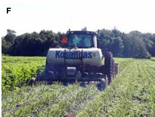
Metoder til vækststandsning A) højspænding (Zasso), B) toptrækning (Rema Toptrækker), C) mekanisk afklipping/knusning af stængler (Crown Crusher), D) topknusning (Grimme), E) varmebehandling (W-jet) og F) brænding (Envo-dan).
